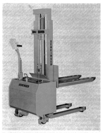
Elektrisch fahren und stapeln bis zu einer Tonne mit dem Genkinger Kleinstapler «Mini Boy 1000». Das neue Gerät ist für Hubhöhen bis 1600 bzw. 2500 mm (Teleskopmast) ausgelegt und benötigt eine minimale Arbeitsgangbreite von 2065 mm (SBB-Paletten längs). Zur Grundausstattung gehört eine leistungsstarke 24-Volt-Anlage mit 125 Ah sowie ein eingebautes Ladegerät. (Foto: Hulftegger+Co. AG, Stäfa)
