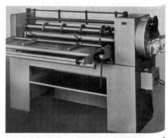
Abbildung 8 Maschine zum Schneiden von Transportbänder auf die benötigte Breite. Es können mehrere Schnitte gleicht zeitig und in beliebigem Abstand ausgeführt werden. Die Maschine ist hier für vier Schnitte ausgerüstet (Messer auf der zweitobersten Walze). Der Vorschub des Bandes geschieht automatisch (Typ aus dem Lieferprogramm der Habasit AGverwendbar bis 1200 mm Bandbreite).
