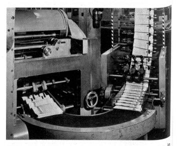
Abbildung 3 Kurven- oder Segmentband. Zeitungen werden in einer Druckerei um eine Kurve von etwa 120° transportiert. Alle Kurvenbänder müssen entsprechend der Abwicklung eines Keger stumpfes zugeschnitten werden (Bild Habasit AG).
