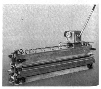
Abbildung 7 Hydraulisch spannbare Heizpresse zum Endvelbinden der beiden Enden von Transportbändern. Von Bandfabrikanten gelieferte Spezialkleber ergeben unter Druck und Temperatur Endverbindungen, deren Qualität bezüglich Zugfestigkeit, Biegesteifigkeit etc. ausserordentlich gut ist (Typ aus dem Lieferprogramm der Habasit AG, verwendbar bis 1200 mm² Bandbreite).
