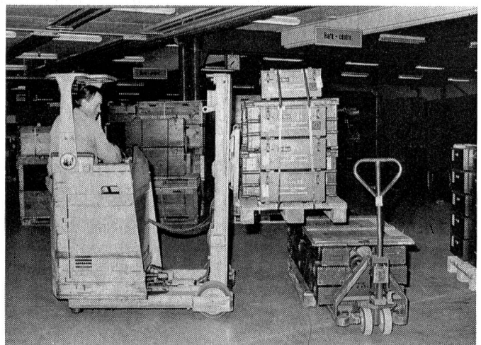
Im innerbetrieblichen Transport werden neben Flurförderzeugen auch Stetigförderer, Hebezeuge und Aufzüge eingesetzt.
