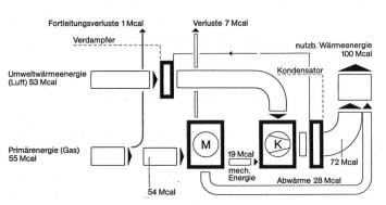
Energieflussbild der Gas-Wärmepumpe.
