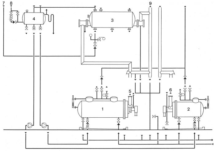
Schema der Dampfzentrale der Textilreinigung AG Niederuzwil: 1 Gasbefeuerter Dampfkessel, 2 Oelbeheizter Dampfkessel, 3 2000 I-Boiler (Abwärmerückgewinnung Gas-Kessel), 4 Speisewassertank, 5 Abgase Gaskessel zur Rückgewinnung bzw. by-pass, 6 Abgase Oelkessel über Dach, 7 Frischwasserzufuhr zu Boiler, 8 Speisewasser, 9 Abgekühlte Abgase nach Rückgewinnung über Dach. (Zeichnung: Koenig, Arbon)
