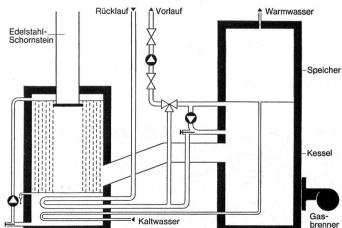
Prinzipschema Abgaswärmerückgewinnung im Bereich des oberen Heizwertes. Links das Kondensations-Rückgewinnungsgerät, in das die Abgase des Kessels (rechts) geleitet werden.
