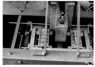
Abbildung 21 Teilansicht des Reutlinger Abriebtesters
