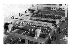
Abbildung 2 Ansicht des Reutlinger Webtesters – a: Sammelklemme, b: Scheuerelemente, c: Einzelklemmen, d: Exzentersystem
