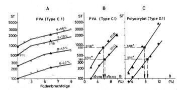
Abbildung 5a A: Lebensdauer-Kennlinie eines PES/Bw-Mischgarns 65/35 16,7 tex (Nm 66), das mit vollhydrolisiertem PVA Type C.1) geschlichtet wurde; B: Scheuertouren ST (1) und ST (6) des mit vollhydrolisiertem PVA (Type C.1) geschlichteten PES/Bw-Mischgarns; C: dgl.: Schlichtemittel: Polyacrylat (Type D.1).
