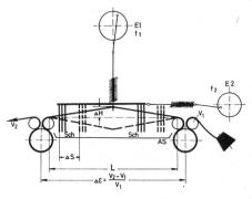
Abbildung 19 Schematische Darstellung des Reutlinger Abriebtesters
