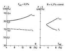
Abbildung 16 Die Abhängigkeit der maximalen Fadenzugkraft  $F_{mox}$  und des plastischen Dehnungsverlustes  $\epsilon_P$  vom Beschlichtungsgrad B und vom Nassdehnungsverlust  $\epsilon_{AE}$  für Zellwollgarn 29 tex (Nm 34).
