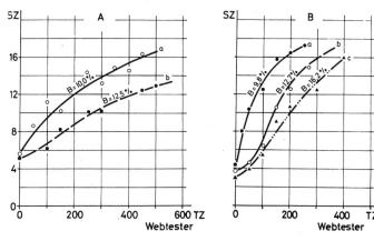
Abbildung 18 Die Abhängigkeit der «Shirley-Ziffer» SZ eines texturierten PES-Filamentgarnen dtex 50 f 18 von der Scheuer-Tourenzahl TZ am Webtester; A: Beim Schlichten mit einem Mischpolymerisat aus Acrylestern (Charakterisierung durch den Hersteller); B: Beim Schlichten mit einer wässrigen Lösung eines Acrylatpolymerisats (Charakterisierung durch den Hersteller).
