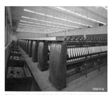
Abbildung 3 Heberlein-Falschzwirnmaschinen, klimatisiert durch Condifil-System: Zuluftkanal unter der Maschine, Abluftöffnungen unter der Decke.
