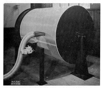
Abbildung 4 Absaug-Trommelfilter
