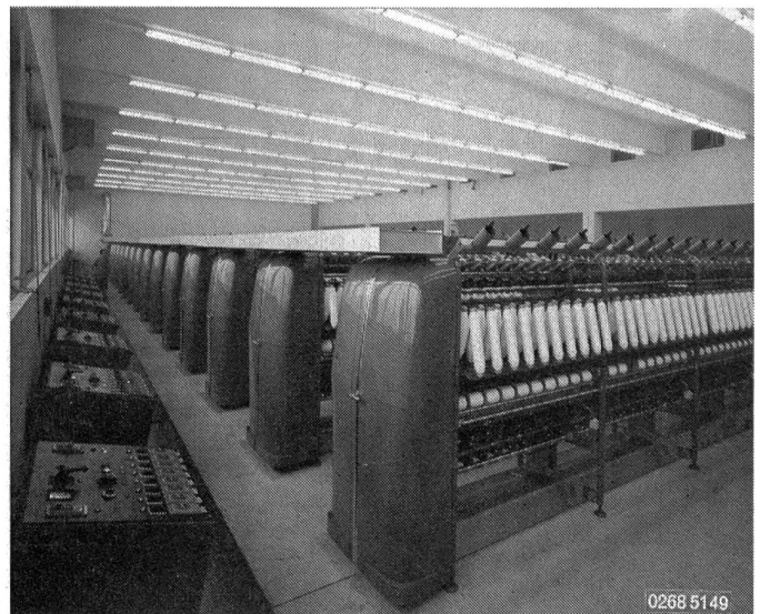
Abbildung 3 Heberlein-Falschzwirnmachines, klimatisiert durch Condifil-System: Zuluftkanal unter der Maschine, Abluftöffnungen unter der Decke.
