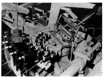
Schussfadenbremse und elektronische Einzelschussüberwachung
