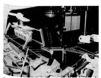
Steuerung zur Schussgarnvorlage an den Greifer
