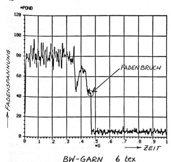
Abbildung 5 Beispiel eines Fadenbruches bei niedrigem Beanspruchungsniveau
