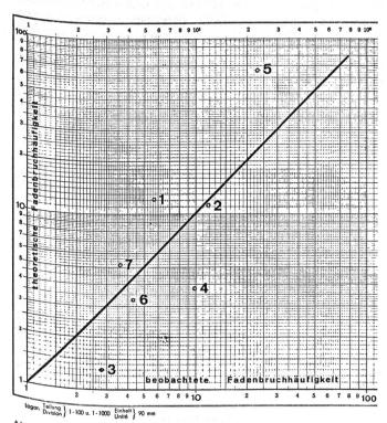
Abbildung 6 Korrelation zwischen theoretischer und beobachteter Fadenbruchhäufigkeit (Versuche 1–7)
