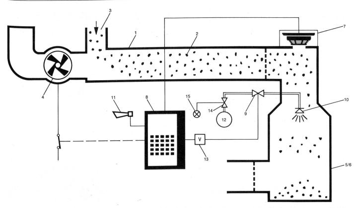
Prinzipschema der automatischen Funken-Erkennungs- und Löschanlage im Faserseparator eines Textilwerks. 1 pneumatisches Transportsystem, 2 Fördergut, 3 Eingabestelle, 4 Ventilator, 5 Filter mit Staubraum, 7 Cerberus-Strahlungsmelder, 8 elektronische Signalzentrale, 9 Schnellventil, 10 Düse, 11 Horn (und weitere Steuerfunktionen), 12 CO<sub>2</sub>-(Halon-)Batterie, 13 Verzögerungsrelais, 14 Druckschalter für Auslösemeldung, 15 Kontrollampe.
