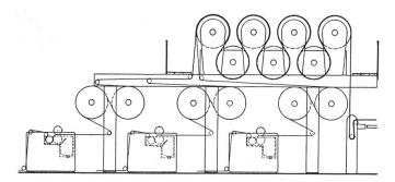
Auch bei einer Trogzahl, die über zwei hinausgeht, braucht auf eine getrennte Vortrocknung der Kettbahnen nicht verzichtet zu werden. Die Darstellung ist eine von vielen Varianten mit einer Vortrocknung ZT-2 für jede Teilkettbahn.
