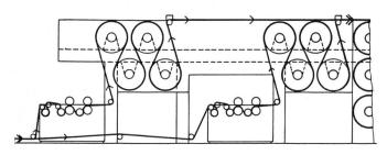
Das Doppeltrog-Verfahren kann durch entsprechend grosse Vortrockner derart verfeinert werden, dass im Endeffekt zwei Ketthälften im Kontinue-Verfahren beschlichtet, fertiggetrocknet und assembliert werden. In den Trocknern nach den Schlichtvorrichtungen können noch weitergehende Nassteilungen praktiziert werden.
