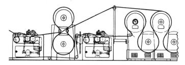
Die Kette wird im Ablaufgestell geteilt und beide Ketthälften getrennt beschlichtet und vorgetrocknet. In Bezug auf die Gleichmässigkeit der Beschlichtung, die Durchschlichtung des Garnes, kombiniert mit der natürlichen Nassteilung, ergibt dieses Verfahren denn besten Effekt und stellt somit die perfekteste Art einer Nassteilung dar.
