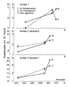
Abbildung 22 Die Abhängigkeit der Kettfadenbrüche pro  $10^{5}$  Schuss vom Reibungskoeffizienten  $\mu$  der Kettgarne. Die Ketten wurden mit Schmelzwachs bzw. mit Flüssigwachs nachbewachst. Die Vergleichsketten wurden nicht bewachst. M: Zahl der Fadenbrüche aus Multimomentaufnahmen; S: Zahl der Fadenbrüche aus der Zählung signierter Fäden; Artikel: 1:5850 Fäden PES/Bw 67/33, 34/34 F/cm, Garnnummer: Nm 34/28; Artikel 2:5846 Fäden PES/Bw 50/50, 39/23 F/cm; Garnnummer: Nm 64/64.
