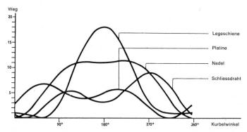
Abbildung 6 Bewegungsdiagramm der maschenbildenden Elemente der Kokett-U
