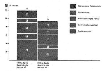
Abbildung 5 Manueller Bedienungsaufwand pro System
