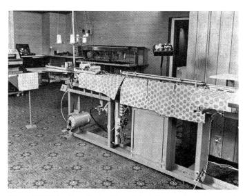
Singer LX 5841 automatische Säumeinheit für gerade und schwach gekrümmten Nahtverlauf (4)
