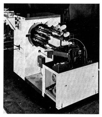
Darstellung des Revolverkopfes der «Pantimatic» mit Lade-, Nähund Ausgabeposition zum automatischen Verschliessen beider Fussspitzen bei Strumpfhosen. Die Schutzverkleidungen wurden zur deutlichen Darstellung abgenommen. (1)
