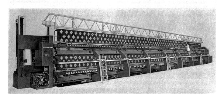
Schrumpfsitze und Klemmverbindungen garantieren starre Verbindungen im ganzen Gatterantrieb. Dabei war ständig zu beachten, dass trotz grosser Steifigkeit die bewegten Massen möglichst klein gehalten werden mussten.
