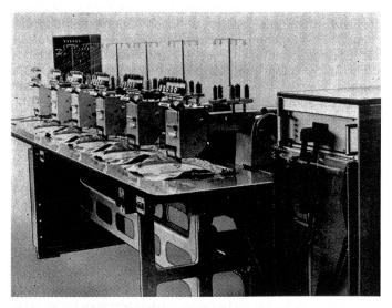
Zangs Fünf-Farben-Mehrkopfstickautomat Typ 168 mit elektronisch gesteuertem Schrittmotorenantrieb
