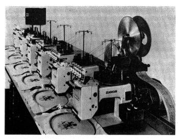
Zangs Fünf-Farben-Mehrkopfstickautomat Typ 168
