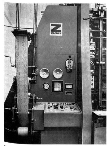
Zangs Hochleistungs-Schiffchenstickmaschine Typ 117 mit elektronisch-hydraulischem Stickrahmenantrieb. Detail: Fotoelektronische Leseeinrichtung für das Kartensystem Saurer.
