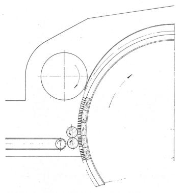
Abbildung 1 Vorreisser mit 2-Einzugszylinder Ø 55
