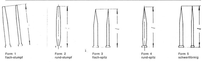
Abbildung 5 Stahlstifte für Belagbretter. Bezeichnung eines flach-stumpfen Stahlstiftes (1) der Stift Nr. 24 (Stahlstift 124 DIN 64110
