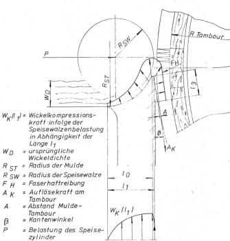
Abbildung 4 Verlauf der Wickelkompressionskraft und Faserhaftkraft
