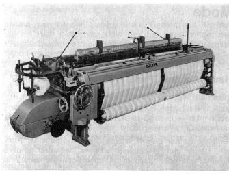
Sulzer-Webmaschine für feine Baumwoll- und Filamentgewebe, Typ 110 ES E 10 K2, zweibahnig belegt mit einem Hemdenstoff aus Polyester/Baumwolle.
