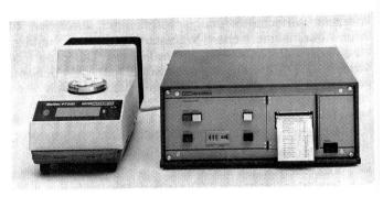
Uster Autosorter mit elektronischer Waage
