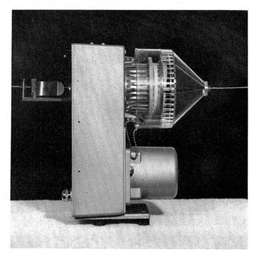
tastet, gesteuert. Durch die elektromechanische Steuerung der Garnreserve erreicht man eine sehr grosse Funktionssicherheit.
