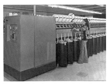
Die neue Rieter Rotorspinnmaschine M 1/1 für den mittleren und groben Nummernbereich
