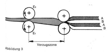
Abbildung 3, die die Verzugszone im Schnitt darstellt, Zeigt deutlich, dass die Streckwerkszylinder E1 und E2 Statistisch gleichviele Möglichkeiten haben, Fasern so-Wohl aus den Schichten A als auch aus den Schichten B Zu erfassen und mitzunehmen.
