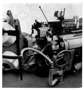
Sulzer-Webmaschine mit Mischwechsler, Typ 153 MW E 10
