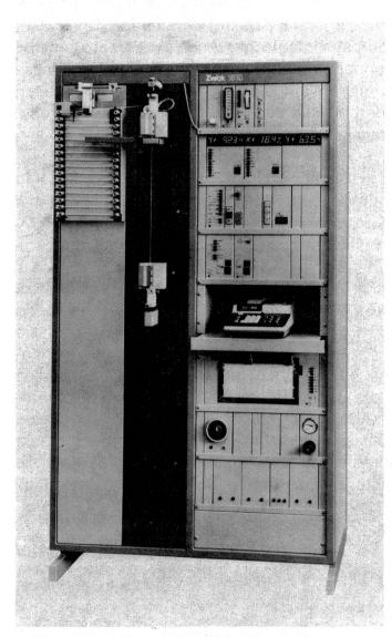
Abbildung 1 Zugprüfmaschine «Zwick 1510»
