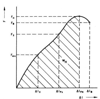
Abbildung 7 Kennwerte für den Zugversuch
