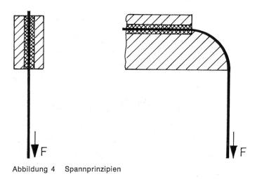
Für die Prüfung klemmempfindlicher Garne (z.B. Glasfasergarne) können spezielle Probenhalter mit Vorspannklemme verwendet werden, mit denen Probenbrüche an der Einspannstelle weitgehend vermieden werden.
