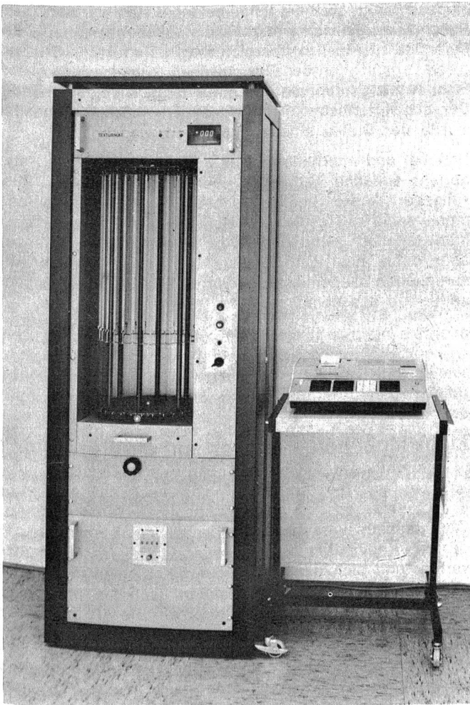
Abbildung 4 Kräuselkontraktions-Messgerät «Texturmat» mit Rechner
