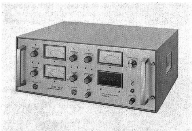
Abbildung 2 Erkatron – Elektronischer Analogrechner für Reibungskoeffizientenrechnung. Geräteausführung mit Digitalanzeige.
