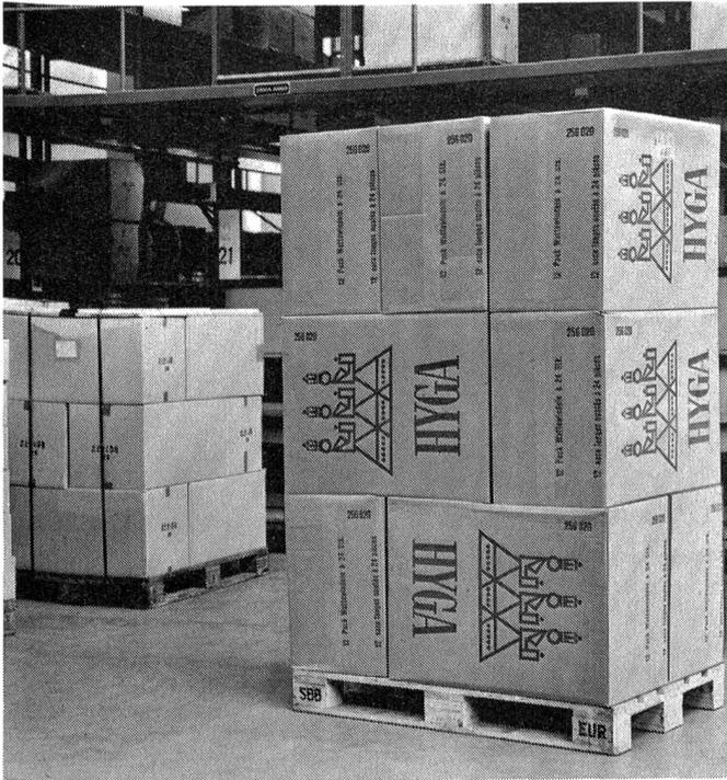
Durch die Wahl der richtigen Ladungshöhe können Warenlager und Transportfahrzeuge optimal ausgenutzt werden.
