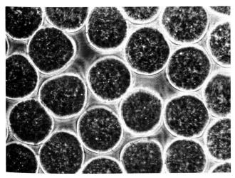
Abbildung 5 Nach zehn Haushaltwäschen bei 40° C zeigen aus gleicher Enka'comfort antistatic-Ware entnommene Filamente im Querschnitt keine Aenderungen (800:1, Phasenkontrast-Verfahren, Foto: TTLM).
