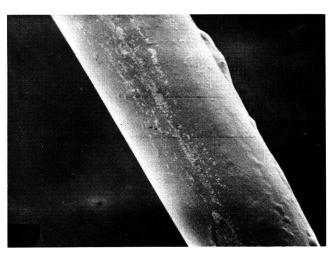
Abbildung 6 Im Raster-Elektronenmikroskop dargestellt: nachträgliche antistatische Ausrüstung an einem Filament aus ungewaschener Ware (1800:1, REM, Foto: TTLM).
