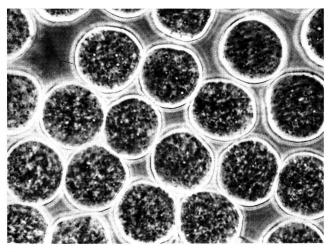
Abbildung 4 Deutlich sehen Sie hier die eingesponnenen Antistatikpartikel bei Filamenten im Querschnitt bei ungewaschener Enka'comfort antistatic-Ware (800:1, Phasenkontrast-Verfahren, Foto: TTLM).
