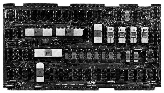
Abbildung 3 Auf dieser Steckkarte (Print) befindet sich ein Mikrocomputer. In der Mitte links ist der Mikroprozessor zu erkennen.
