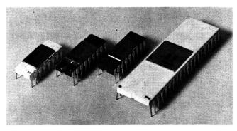
Abbildung 1 Von den vier «Integrierten Schaltkreisen» ist der äusserste rechts (Bezeichnung 8080) ein Mikroprozessor.
