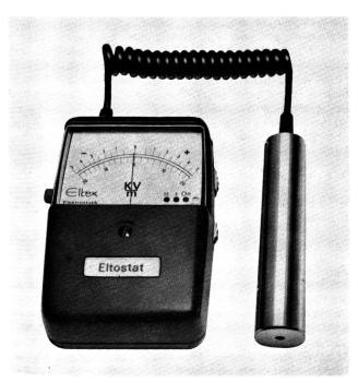
Abbildung 5 Eltex-E-Feld-Messgerät EM 01. Handliches Kleingerät mit separater Messonde zum Messen elektrostatischer Aufladungen an Fäden und Bahnen.
