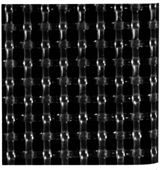
Abbildung 1 Maschengewebe in starker Vergrösserung. (Monordur der Vereinigten Seidenwebereien AG)
