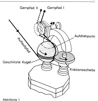
Der Fadenlauf auf der zweiten Halbkugel entspricht der Form eines Kommas, wobei sich der Fadenpfad durch einfache Fadenleitorgane optimal in Bezug auf Drallerteilung und Laufruhe einstellen lässt.
