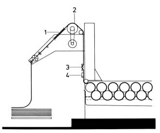
Schema Wareneinführung: 1 pneumatischer Kantenausstreifer, 2 Transportwalze, 3 Leistenausroller, 4 Kantenführer.
