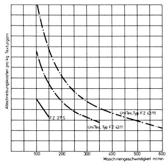
Abbildung 2 Abschreibungskosten pro kg Textilgarn dtex 167 bei verschiedenen Geschwindigkeiten (Wirkungsgrad 100  $^{0}/_{0}$ )
