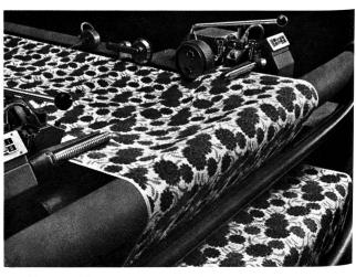
Abbildung 6 Spannrahmeneinlauf Famatex
