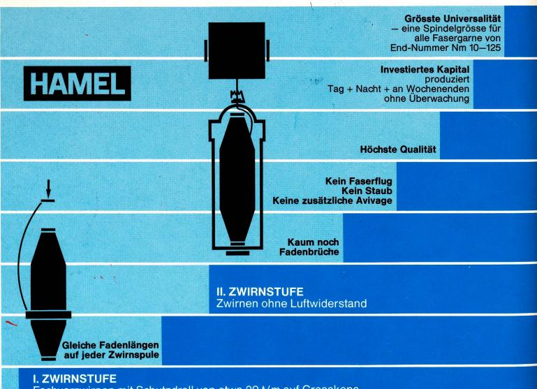
Fachvorzwirnen mit Schutzdrall von etwa 20 t/m auf Grosskops mit gleichzeitiger Meterzählung
