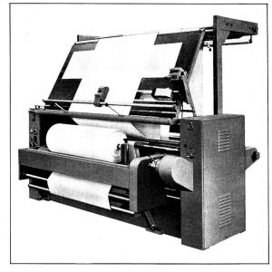
Stoffbeschau-, Mess- und Rollmaschine CT 5206 Ah/l für Wirk- und Webware mit Wareneinlauf ab Rolle und Stapel. Indirekte Aufrollung mit selbstregulierender Warenspannung und automatischer Kantenführung. Spannungsfreie Abrollung durch automatisch gesteuerten Separatantrieb. Exakte Längenmessung (eichfähig). Stufenlose Geschwindigkeitsregulierung von 0–60 m. Einfache und leichte Bedienung.
