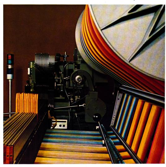
Seitenansicht mit Polkettenlauf und zentralem Frottieraggregat
