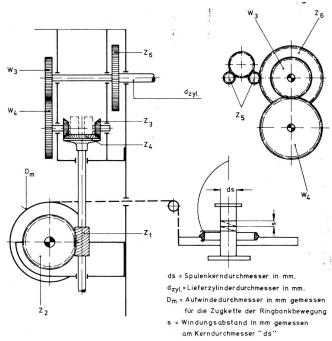
$\underline{\text{Windungsabstand}} \quad \text{"s"} = \frac{\text{ds} \quad D_m \quad \mathcal{I} \cdot Z_1 \cdot Z_3 \cdot Z_5 \cdot W_3}{\text{dzyl.} \cdot \quad Z_2 \cdot Z_4 \cdot Z_6 \cdot W_4}$
