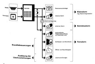
Das Prinzip einer Brandmelde-Anlage: der Alarm kommt von einem Melder oder einem Handalarm-Taster zur Zentrale, diese leitet ihn — je nach Alarmorganisation — an vorprogrammierbare Stellen weiter und steuert weitere Funktionen wie etwa das Schliessen der Rauchschutzklappen etc. (Foto Cerberus AG)
