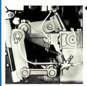
Zentralschmierung am Parallelschlag.
