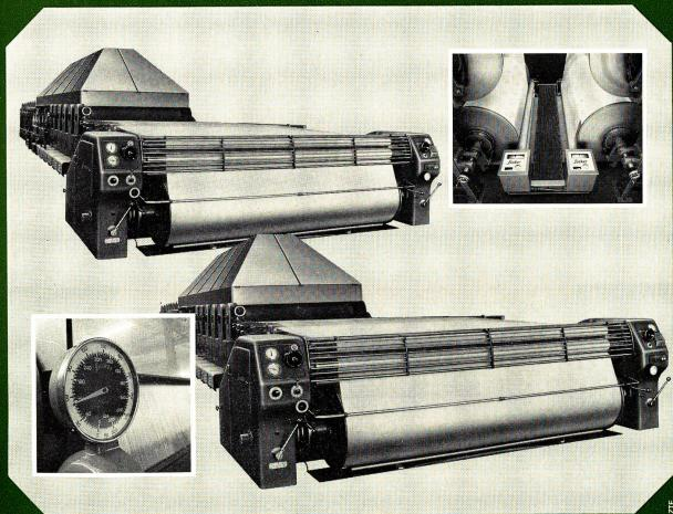
Hochleistungs-Schlichtmaschine für Stapelfasergarne
