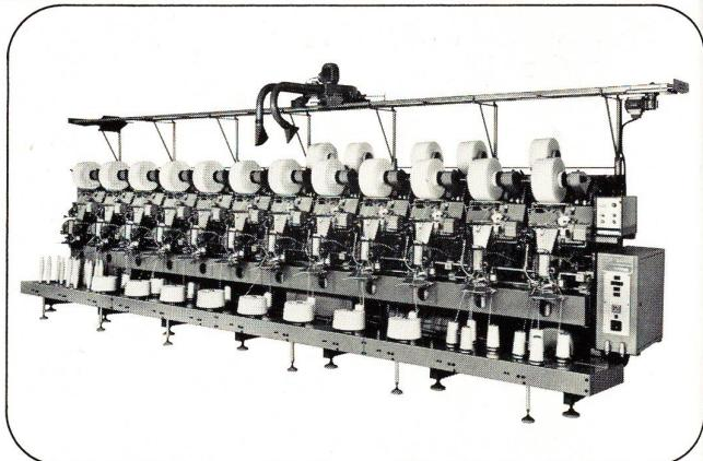
Die immer höheren Leistungsgrenzen der schützenlosen Webmaschinen fordern Schussvorlagen, die problemlos (und möglichst ohne Zusatzgeräte) ablaufen und über-springen. Die Präzisionwicklung der Kreuzspule mit konstantem Windungsabstand (wie sie nur mit Schärer-Maschinen erreicht werden kann) gewährleistet gleich-mäßige Abzugsspannung und verhindert dadurch viele Fadenbrüche, hilft die Leistung der Webmaschinen zu steigern und wirkt sich positiv auf die Gewebequalität aus.
