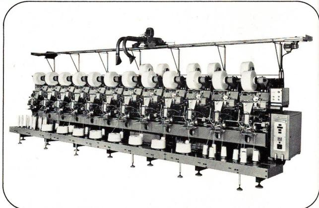
Die immer höheren Leistungsgrenzen der schützenlosen Webmaschinen fordern Schussvorlagen, die problemlos (und möglichst ohne Zusatzgeräte) ablaufen und über-springen. Die Präzisionwicklung der Kreuzspule mit konstantem Windungsabstand (wie sie nur mit Schärer-Maschinen erreicht werden kann) gewährleistet gleich-mäßige Abzugsspannung und verhindert dadurch viele Fadenbrüche, hilft die Leistung der Webmaschinen zu steigern und wirkt sich positiv auf die Gewebequalität aus.
