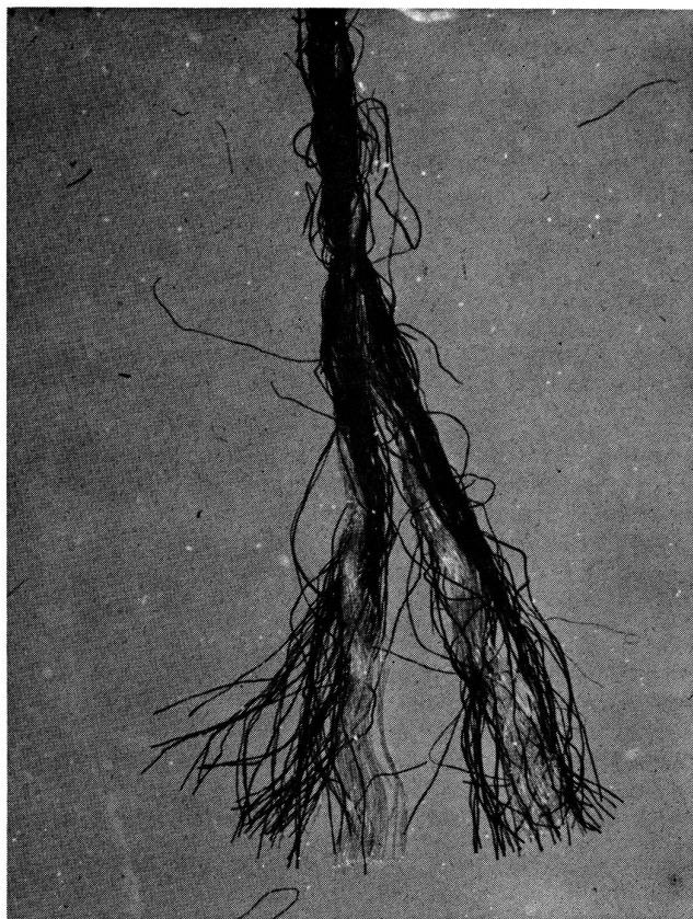
Makroaufnahme eines Kerngarnes aus zwei Einzelkomponenten: Die Seele ist hell erkenntlich und die Umspinnung durch Baumwollfasern ist dunkel angefärbt.
