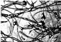
Bild 9: Verfestigung mittels Schmelzklebefasern Grilon K-115
