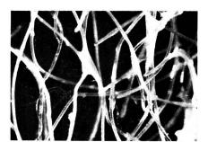
Bild 8: Sprühverfestigtes Vlies
