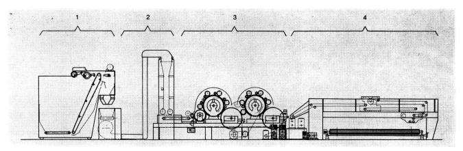
Bild 2: FOR-Krempelvlies-Anlage zur Herstellung von kreuzgelegten Vliesstoffen. 1 Wiegekasten-Speiser, 2 volumetrische Beschickung, 3 Krempel, 4 Flortäfler
