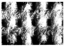
Bild 12: Bikomponenten-Faservlies, heissprägeverfestigt
