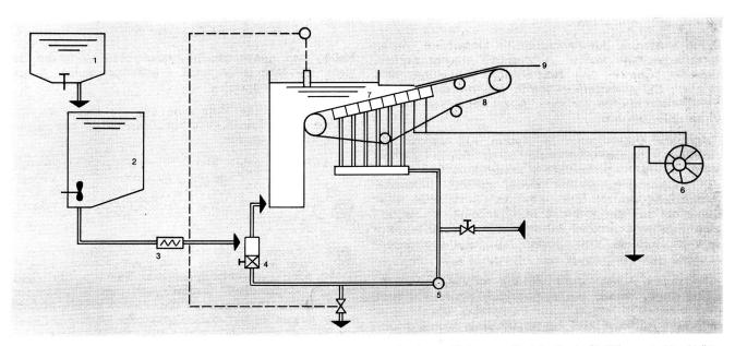
Bild 4: Schema einer Voith-Nassvlies-Maschine (Hydroformer; weisse Partien = Siebwasser-Kreislauf). 1 Stofflöser, 2 Mischbütte, 3 Dosierpumpe, 4 Mischer und Regler, 5 Verdünnungswasserpumpe, 6 Vakuumpumpe, 7 Blattbildung, 8 Sieb, 9 Vlies; Auslauf zum Trockner
