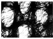
Bild 6: Wasserstrahlverfestigtes Vlies nach dem «Spunlaced»-Verfahren
