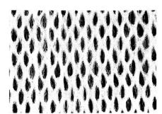
Bild 11: Wasserstrahldurchbrochenes Vlies, chemisch verfestigt
