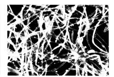
Bild 7: Foulardimprägniertes Vlies
