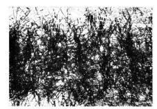
Bild 5: Querschnitt durch ein vernadeltes Vlies
