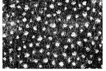
Bild 13: Pulverpunktbeschichteter Einlagevliesstoff
