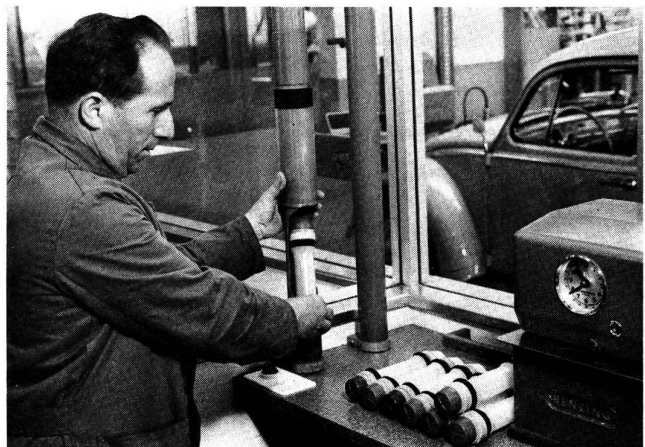
Rohrpost: Basis und Garantie für einen rationellen, beschleunigten und reibungslosen Materialfluss. Schiebesende- und Empfangsstation für 2-Punkt-Anlage.
