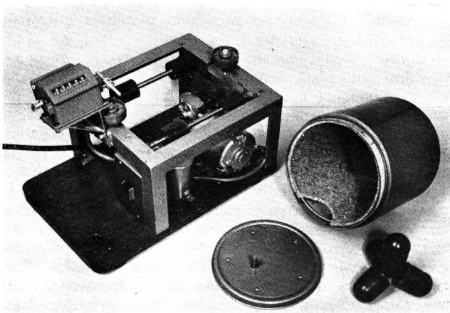
Tetrapod Walker Machine. Vorne rechts ist der Vierfuss, der in der Trommel auf dem Teppich frei beweglich 400 000 Touren abläuft.
