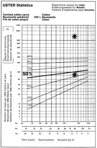
Abbildung 7 Zählungen der Nissen mit dem Uster Imperfektion Indicator an einem kardierten und einem gekämmten Baumwoligarn. Der tiefere Wert entspricht der Messung ab Spinnkops, der höhere Wert nach sechs Umspulungen.
