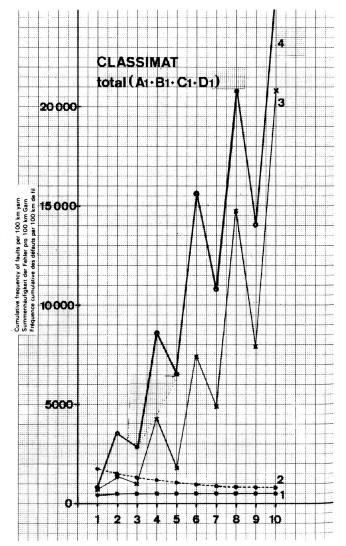
Abbildung 4 Abhängigkeit der Dickstellenzahl von der Spulrichtung. Senkrecht ist die Summenhäufigkeit aller Classimatzählungen, waagrecht die Anzahl der Spulungen aufgetragen. – Die Kurven bedeuten: 1 Gekämmte Baumwolle, 2 Kardierte Baumwolle, 3 100 % Acryl, Baumwolltype, 4 Wolle/Polyester Mischgarn.
