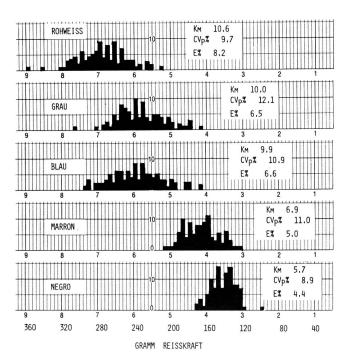
Abbildung 8 Häufigkeits-Diagramme der Reiskraft, aufgenommen mit dem automatischen Dynamometer Uster. Die fallende Reisskraft wurde durch den Färbeprozess verursacht.
