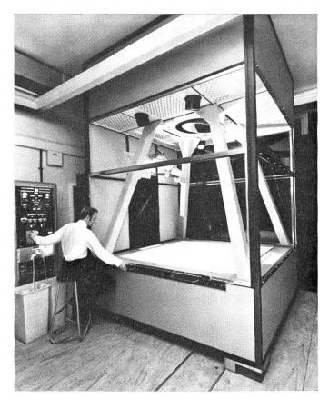
Numerisch gesteuerter Strahllenker für automatisches Zuschneiden von Kleidermodellen mit Laser
