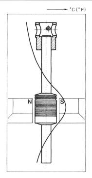
Abbildung 7 Temperaturprofil des HE-Q-MA-Drehrohres
