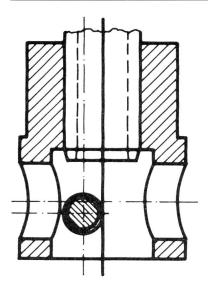
Abbildung 6 Zwirnkopf mit exzentrisch angeordnetem Drallgeber
