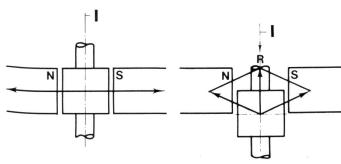
Abbildung 10A Vektorielle Magnetfeldanordnung in axialer Richtung (Drehrohr unbelastet) I = Fadenlauf
