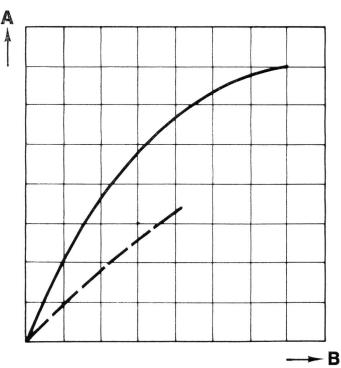
Abbildung 11 Kraft-Weg-Verhalten des Drehrohres in axialer Richtung: A = Axiale Tragkraft, B = Auslenkung (Weg)
