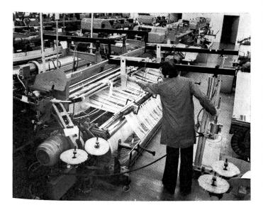
Lage geschwenkt, das Webeblatt in die Lade eingesetzt und die einzelnen Schäfte mit den Schaftantriebselementen verbunden. Die Tragarme können hydraulisch gehoben oder gesenkt werden, um die Schäfte in die gewünschte Lage in der Webmaschine zu bringen. Die Abbildung zeigt die neue Ladevorrichtung beim Einlegen des Webegeschirres in die Webmaschine. Das Schaftpaket wurde bereits in die horizontale Lage geschwenkt.
