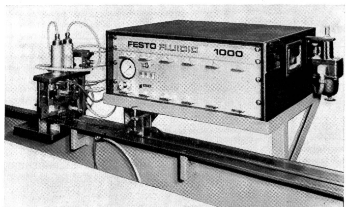
Abbildung 9 Stanzeinrichtung für Programmkarten von Jacquard-Strickmaschinen. Die Steuerung ist im Festo-System 1000 ausgeführt und in einem 19"-Gehäuse untergebracht.
