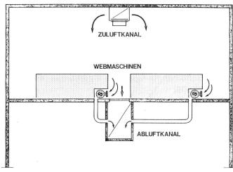
Abbildung 20 Separate Abführung der Motorenwärme von Webmaschinen
