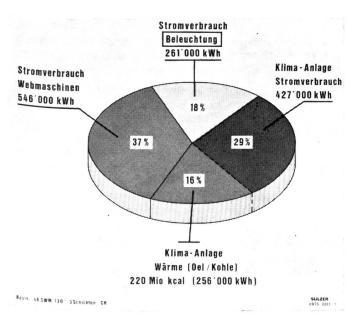
Abbildung 27 Anteil der Beleuchtung am Gesamtenergiebedarf einer Baumwollweberei
