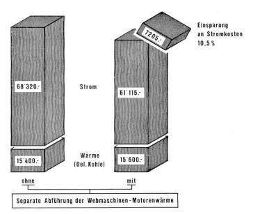
Abbildung 22 Energiekosten-Einsparung durch eine separate Abführung der Motorenwärme der Webmaschinen (bei Klima-anlagen – in SFr.)
