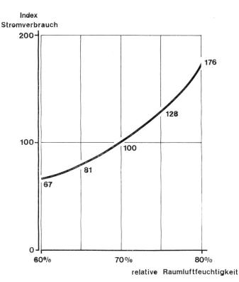
Abbildung 17 Korrelation zwischen Stromverbrauch und relativer Raumluftfeuchtigkeit
