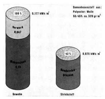
Abbildung 30 Strombedarf in kWh/m² von Web- und Strickmaschinen bei der Herstellung eines qualitativ vergleichbaren Stoffes (Quelle: Gebr. Bodmann)
