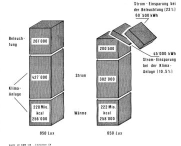
Abbildung 28 Stromeinsparung in kWh durch gleichmässiges Absenken der Beleuchtungsstärke von 850 auf 650 Lux
