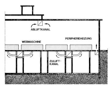
Abbildung 24 Luftführung bei einer Arbeits- und Bedienungszonen-Klimatisierung
