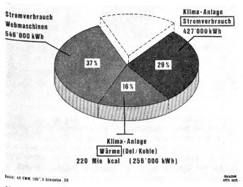
Abbildung 16 Anteil der Klimaanlage am Gesamtenergiebedarf einer Baumwollweberei
