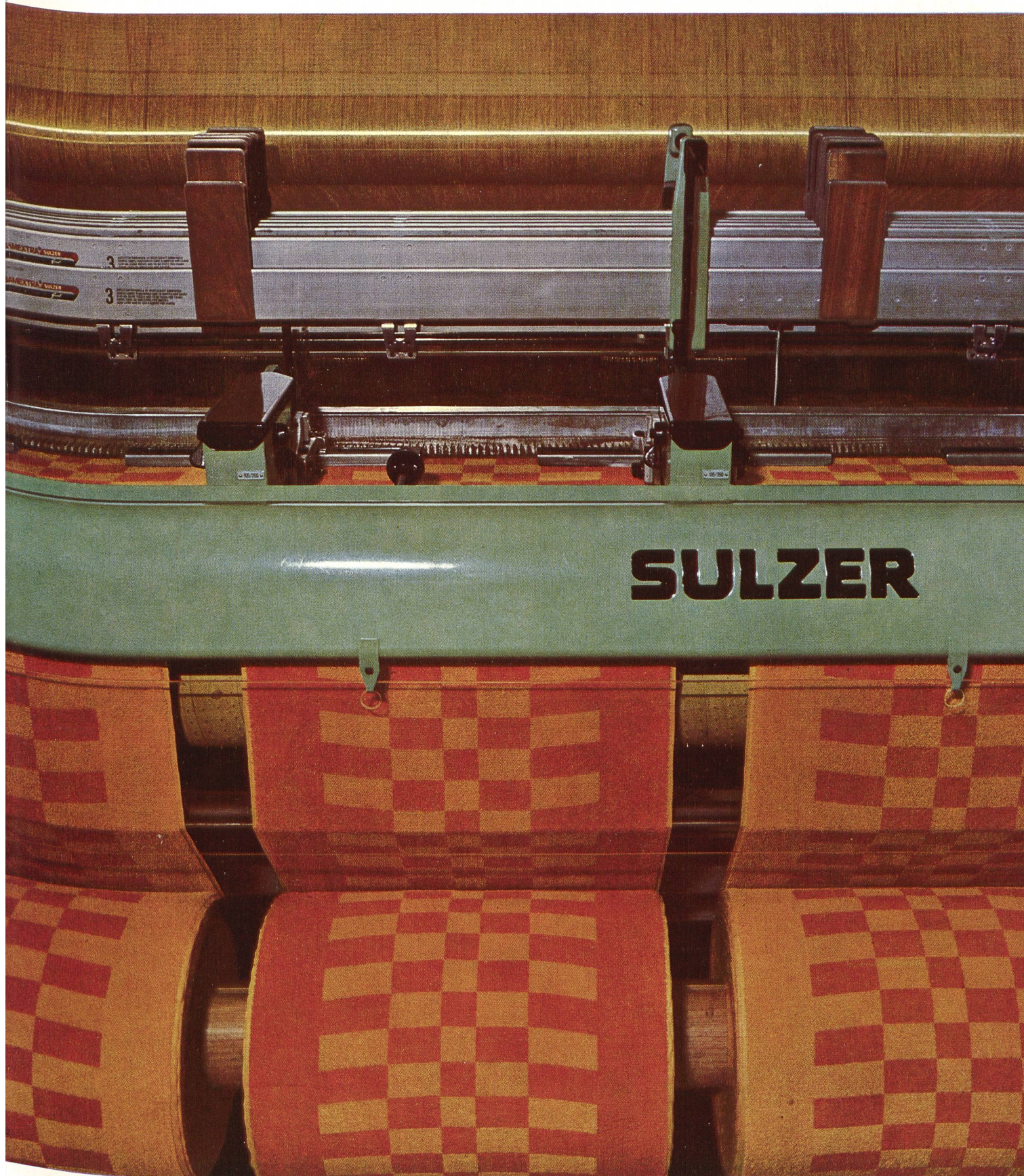
Mehrbahniges Weben auf der SULZER-Frottierwebmaschine
