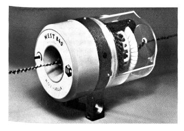
Unter der Typenbezeichnung «West 840» fertigt die Firma Roj+Vella S.p.A., Biella, einen Schussfadenspeicher, der als hauptsächlichstes Merkmal den Schussfaden auf einen konischen Körper aufwickelt und aus dessen Innenseite abnimmt. Dadurch wird eine äusserst gleichmässige Abwicklung gewährleistet, unabhängig von den Abmessungen und der Form der Kreuzspulen.
