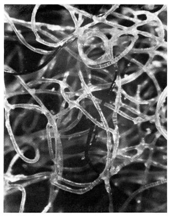
Die Vergrösserung eines Ausschnittes aus einem Tultrim-Teppich zeigt, wie die Heterofil-Fasern sich an allen Kontaktstellen mit anderen Fasern verbinden und eine elastische, dimensional stabile Struktur ergeben. Dies wird durch Verwendung von Fasern erreicht, die sich aus zwei verschiedenen Nylonarten zusammensetzen (ICI Fibres Ltd., 68 Knightsbridge, London SW1X 7LN).
