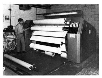
Diese Maschine des Typs BTP 72 bedruckt synthetische Gewebe sowie synthetische Mischgewebe mit maximal  $25\,^0/_{
